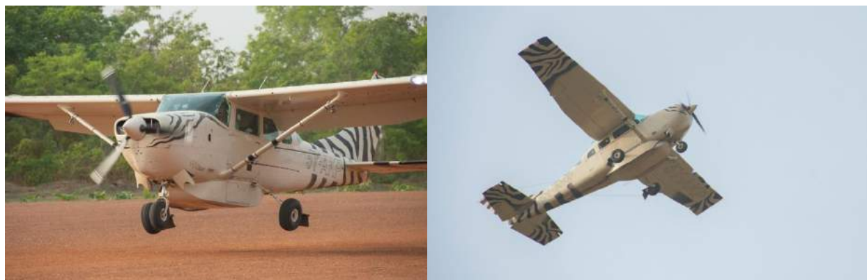
Figure 2. Avion Cessna 206 5Y-AKP avec ailes hautes modifiées spécialement pour les inventaires de faune pour plus de portance à basse vitesse.
